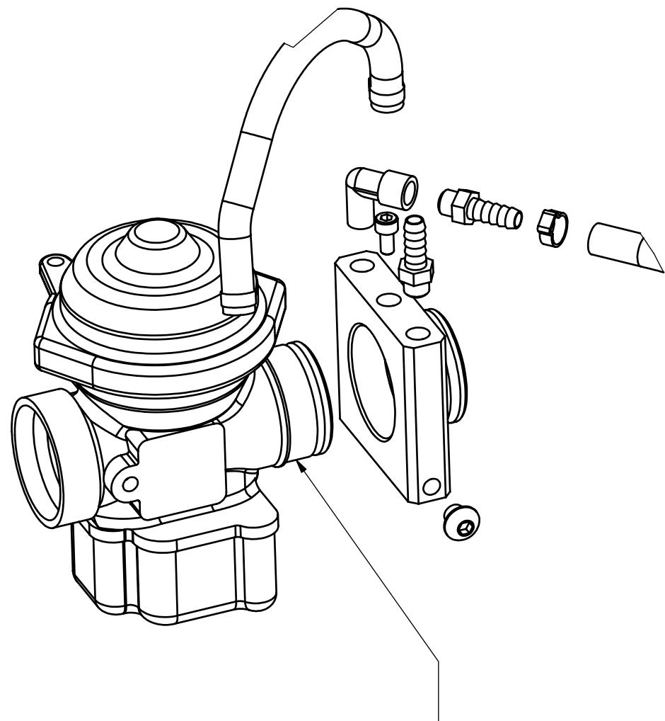
Avant de monter la réchauffe mettre un cordon de colle étanche (K+D type E de chez WURTH) précisément à cet endroit pour assurer l'étanchéité carbu/réchauffe.
