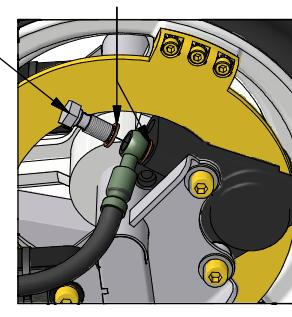
**Contre-percer le carénage Ø8 puis réaliser une lumière dirigée vers l'arrière du tricycle.**
