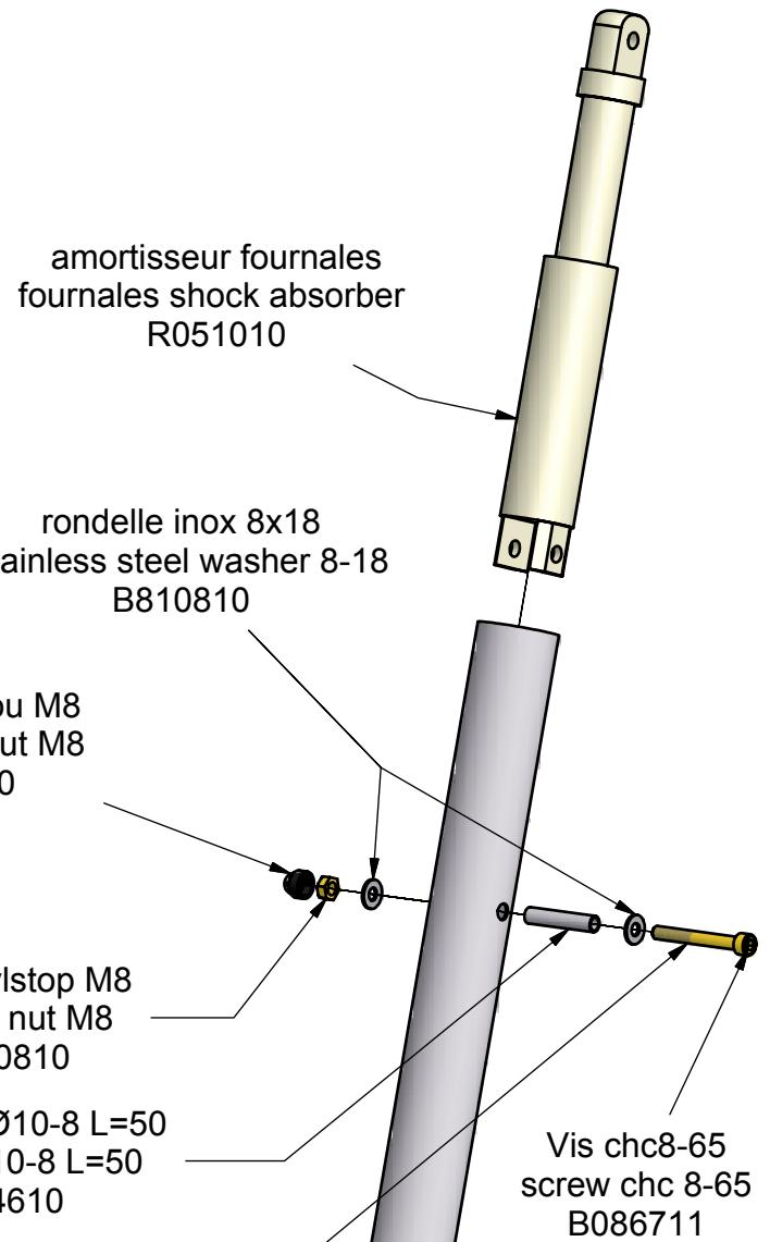
**Attention: Le sens de montage des vis est toujours réalisé par sécurité de l'avant vers l'arrière du tricycle. Il est donc impératif d'inverser le sens de montage de la vis Chc 8x65 entre l'assemblage tube amortisseur droit et gauche.**
