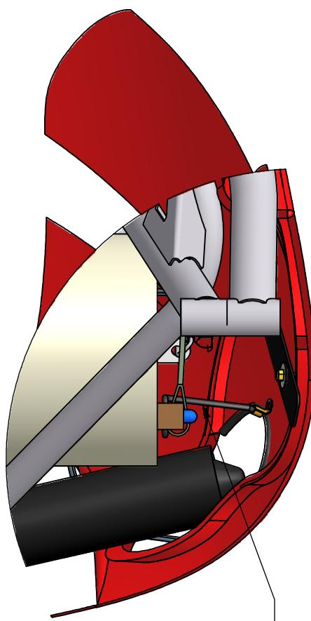
Attacher l'élastique de la porte parachute sur le pontet du container parachute. L'élastique doit être en tension.
